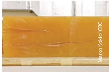
两种不同的9mm手枪子弹射进肥皂块形成的弹道
