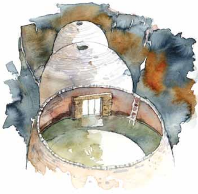
Corte transversal de un módulo biodigestor de 100 m 3
