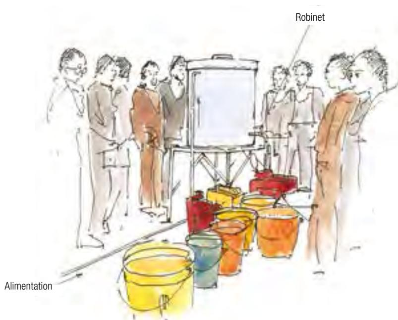
**Figure 19** Réservoir de stockage dans les locaux de détention et récipients individuels
