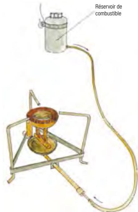
Figure 86 Réchaud à pétrole à pression gravitaire
