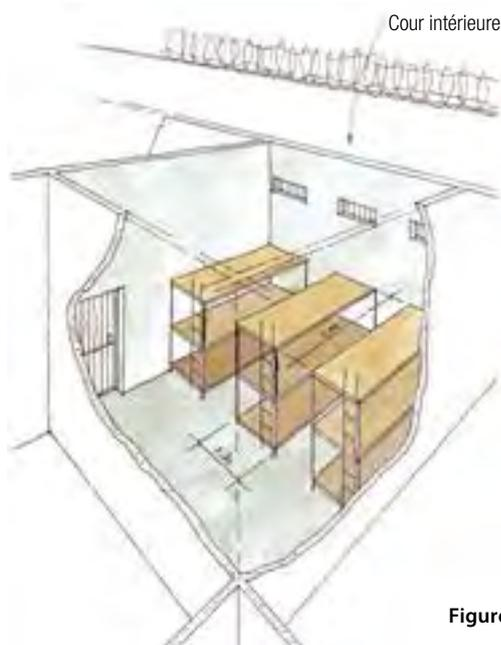
**Figure 7** Agencement de lits superposés respectant les critères minimaux de surface de couchage
