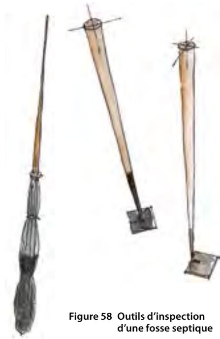
Figure 58 Outils d'inspection d'une fosse septique
