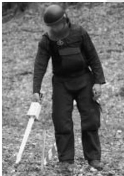
Un artificier vérifie que son détecteur fonctionne avant de commencer à rechercher des sous-munitions non explosées.
