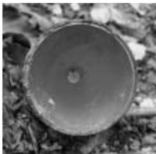
Sous la pression de l'explosif placé derrière lui, le cône métallique de la sous-munition RBL755 se retourne et se transforme en jet de métal capable de perforer le blindage d'un char.
