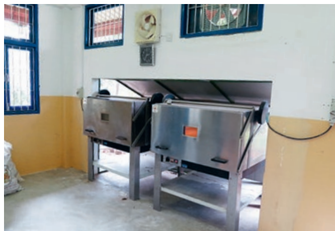
Illustration 2.1.4.13 Département P&O – salle de thermoformage avec ses fours encastrés dans le mur de façade, 2014 J. Curras Paredes/CICR
