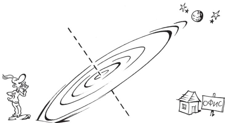
Когда вы будете в следующий раз на выезде, обратите внимание, как много ваших транспортных средств имеют очень аэродинамично наклоненные назад антенны. Это выглядит очень круто, но они не обеспечивают крутую радиосвязь. **Все антенны должны быть вертикальными.**
